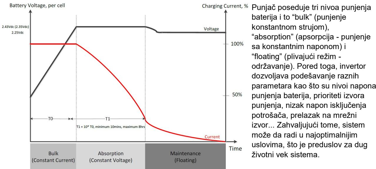
**Solarni sistem 400W/1000W** omogućava\* napajanje rasvete, televizora i frižidera. Preporučuje se korišćenje štedne rasvete, televizora snage do 50W i frižidera dnevne potrošnje do 500Wh.
